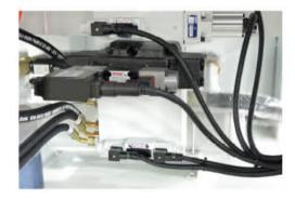
开关模动作采用比例方向阀控制,具有动作加速迅速、 高速运行平稳、开模位置控制精准的特点。
