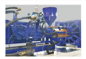
专用的单缸注射结构, 大幅减少高速注射时的回油油量, 降 低了注射时的回油压力,从而提高了机器注射时的加速度。
